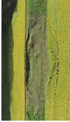
水田法面崩壊(奥出雲町)
